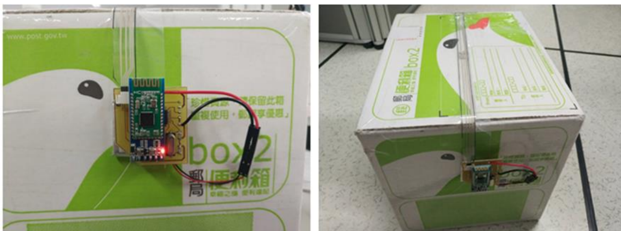
圖 11 以 iTape 智慧聯網膠帶封裝之貨物箱
